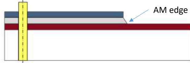
6. Etch AM foil, producing precision optical edge
