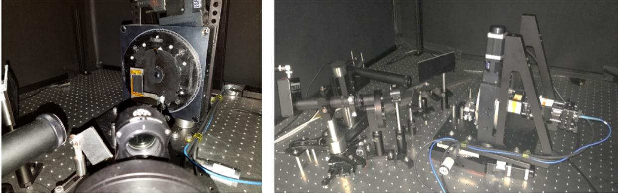
Figure 9: Edge scatterometer at JPL.
